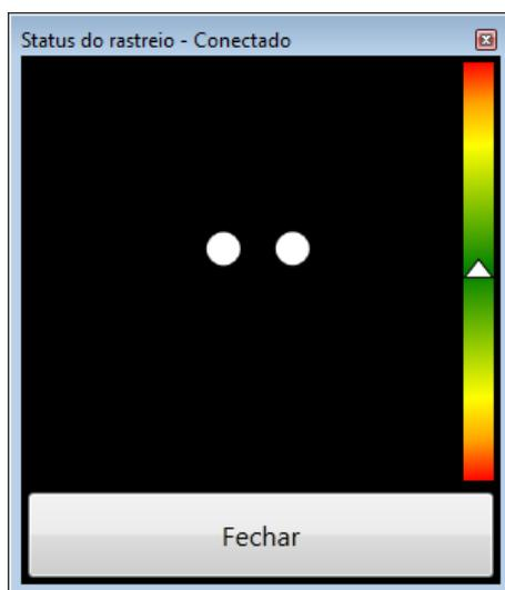
Utilize o Visualizador do status de eye-tracking (consulte a seção 5.3.3.1 *Exibição do status de eye-tracking*, página 28 para obter mais informações sobre como abrir o Visualizador do status de eye-tracking) para ajudar a determinar a altura e posicionamento horizontal ideais para o Gaze Interaction com o Tobii Dynavox I-Series+.
