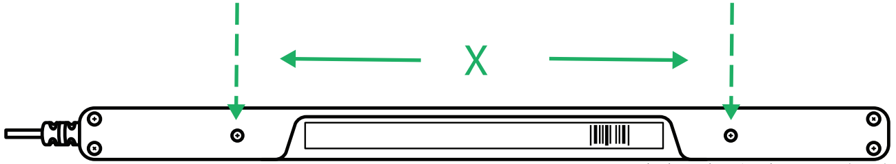
الرسم التوضيحي 2: المسافة من المركز إلى المركز بين مسامير M3
