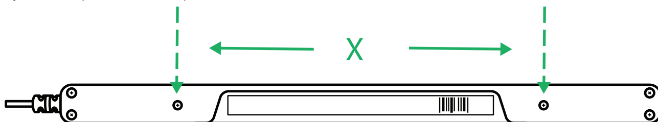
Ilustrace 2: Vzdálenost C – C mezi šrouby M3
