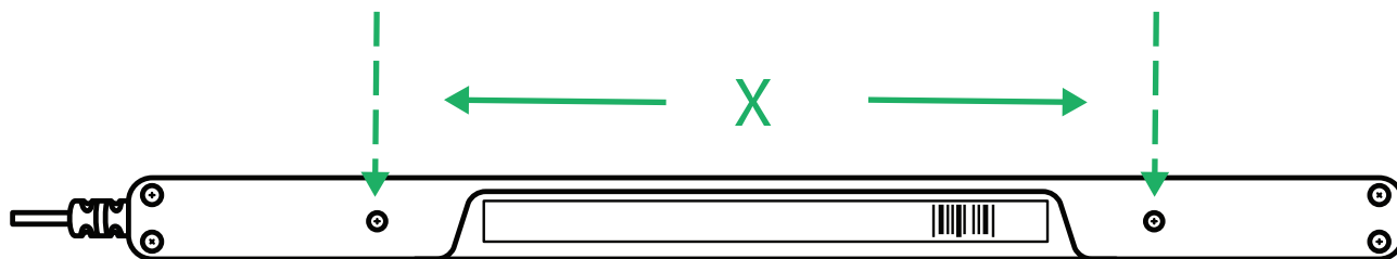
Illustration 2: Afstand fra midtpunkt til midtpunkt mellem M3-skruerne
