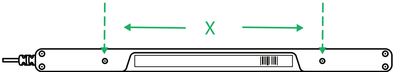
Ilustración 2: Distancia de centro a centro entre los tornillos M3
