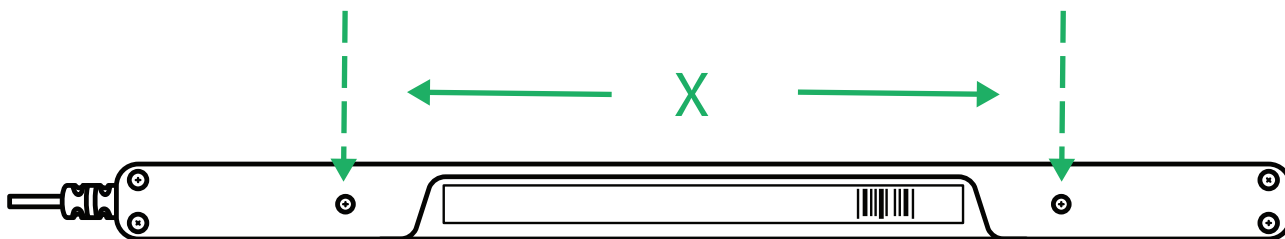
Ilustracja 2: Odległość C-C między wkrętami M3
