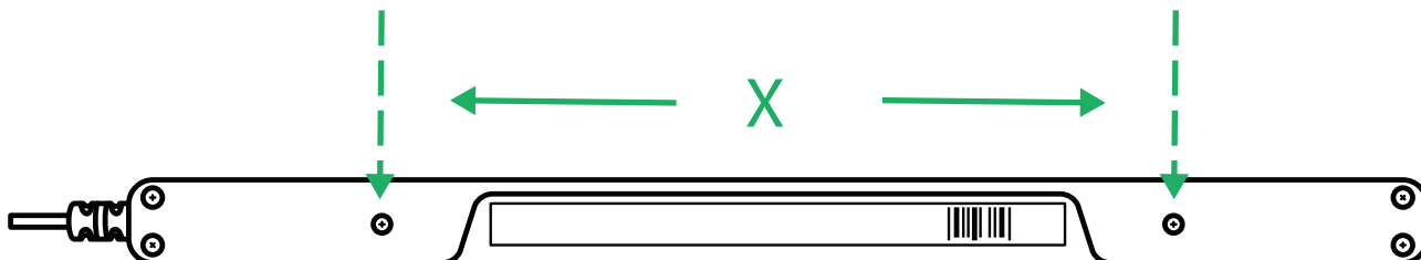
Иллюстрация 2: Расстояние между центрами винтов M3
