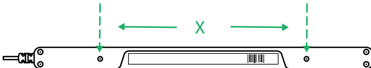
Ilustracija 2: Razdaljina od centra jednog M3 šrafa do drugog
