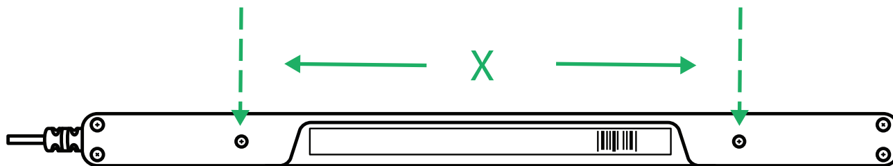
Figur 4.1 Afstand fra midtpunkt til midtpunkt mellem M3-skruerne
