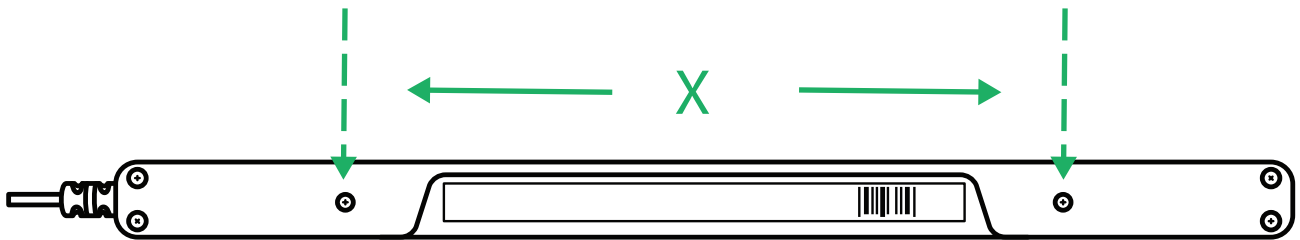
Kuva 4.1 C-C -etäisyys M3-ruuvien välillä
