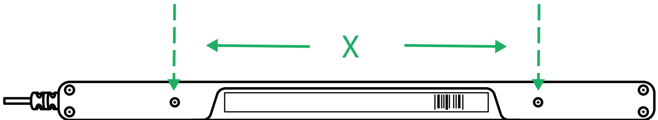
図 4.1 M3ネジ間のC-C距離
