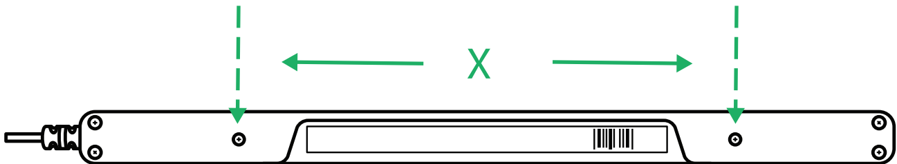
Figur 4.1 C–C-avstanden mellom M3-skruene
