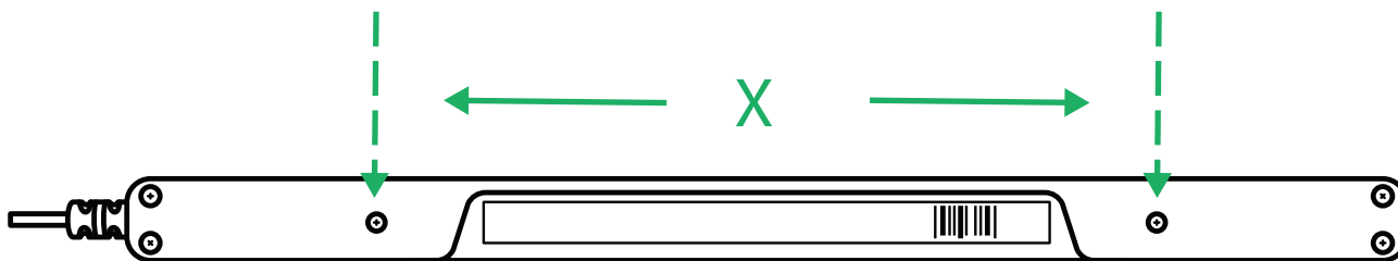
Afbeelding 4.1 C-C-afstand tussen de schroeven van M3
