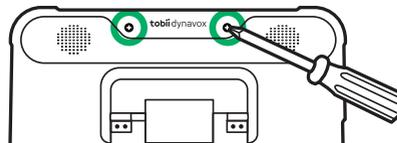
❼ Relevez le support pliable et serrez les deux vis situées dans la partie inférieure.
